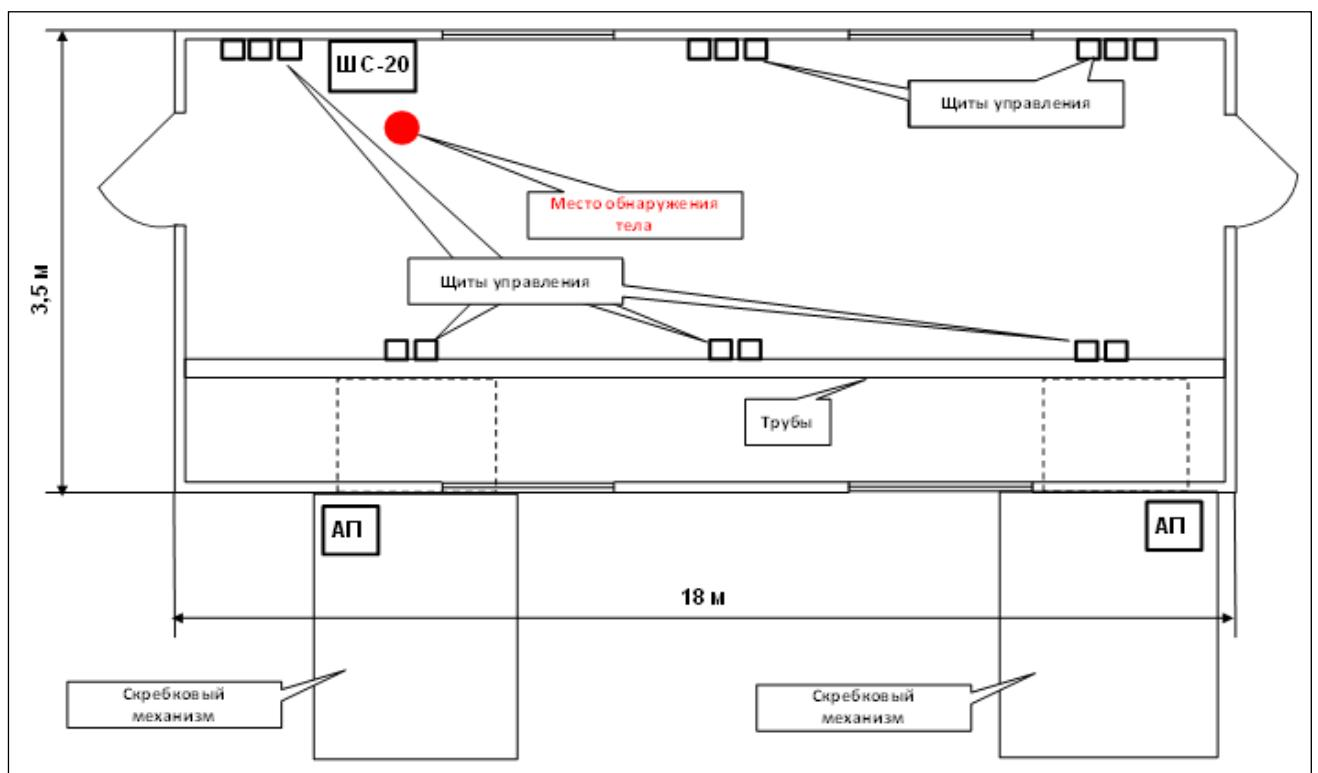
По поручению инженера-энергетика после 09:00 в здание песколовки зашёл инженер, чтобы в том числе проверить работу электромонтёра 1. Инженер застал электромонтёра 1 у силового шкафа ШС-20, где он сидел на корточках и разделял обесточенные концы кабеля, выходящие из лотка рядом со шкафом ШС-20. Инженер осмотрел шкафы и проинструктировал электромонтёра 1 о технике безопасности: о необходимости выключения рубильников перед проведением работ и вывешивания запрещающих плакатов.
